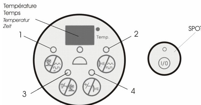
Pour obtenir l'effet VENTURI, tourner le bouton de réglage jusqu'à l'obtention de la puissance désirée.
